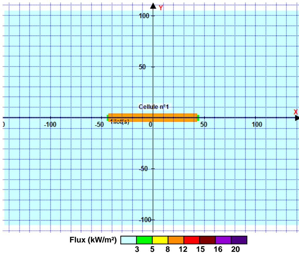
Pour information : Dans l'environnement proche de la flamme, le transfert convectif de chaleur ne peut être négligé. Il est donc préconisé pour de faibles distances d'effets comprises entre 1 et 5 m de retenir une distance d'effets de 5 m et pour celles comprises entre 6 m et 10 m de retenir 10 m.
